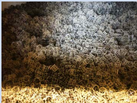
Austausch der alten Füllkörper im Gegenstromwäscher – Bild links: alte Füllkörper, Bild rechts: strukturierte Packung
