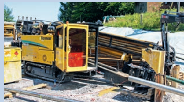
Grossbohranlage für Bohrungen länger als 300 m
