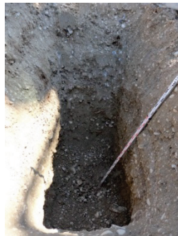
Versickerungsversuch mit Baggerschlitz (Quelle: Kuster + Hager AG)
