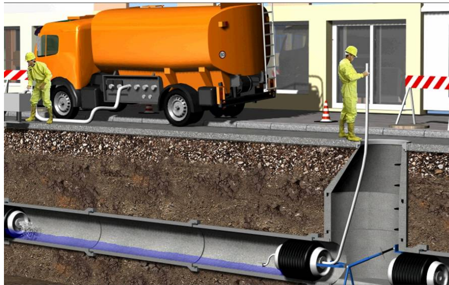
Bild 18: Dichtheitsprüfung schematisch dargestellt
