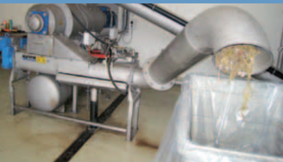
Hammermühle zur Zerkleinerung und Fremdstoffentfernung von biogenen Abfällen
